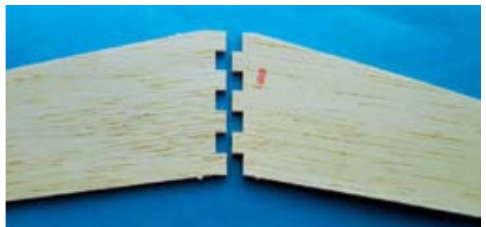
Wie bei einem Legobaukasten sind die Holzteile zu stecken oder, wie hier beim Leitwerk, zu verzapfen – eine sehr gute Bauhilfe
