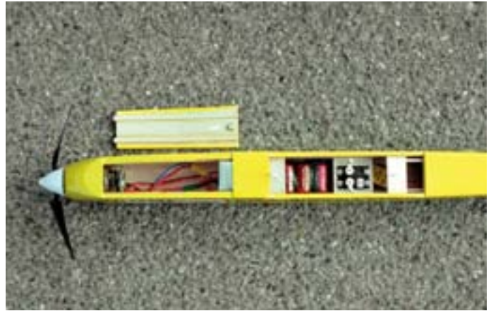
Bei der Elektroversion sind Akku, Empfänger und Servo um den Schwerpunkt angeordnet
