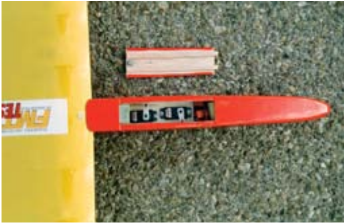
Beim Segler gilt die Devise: Alles nach vorne. Am Rumpfdeckel ist der Powermagnet sichtbar.
